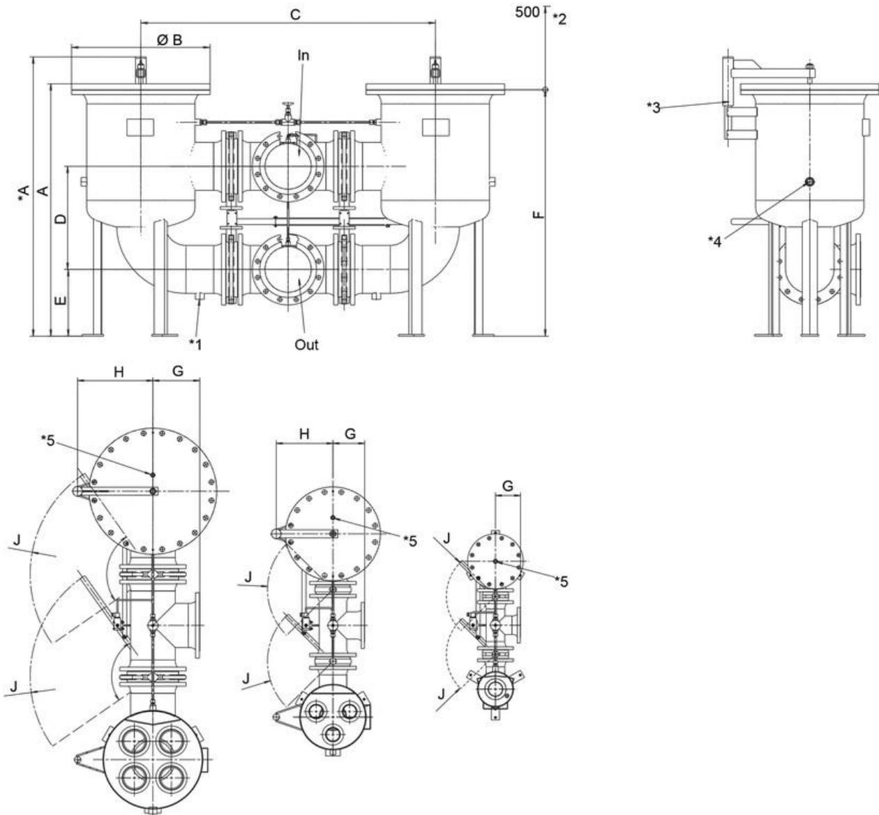
A für Pi 281125-281180    \*1 Ablassanschluss G½    \*3 Deckelabhebevorrichtung    \*5 Entlüftungsschraube G½    In = Einlass
