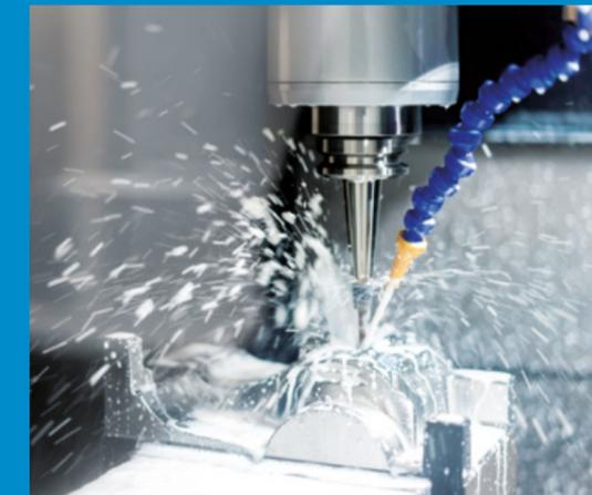
Sogenannte mehrspindlige Bearbeitungszentren kombinieren mehrere Zerspanungsprozesse in einer Maschine. Beim Fräsen und Bohren kommt an den einzelnen Bearbeitungsplätzen ein wasserlöslicher Kühlschmierstoff zum Einsatz, der direkt an der Maschine abgesaugt und in einem Filtersystem aufbereitet wird.
