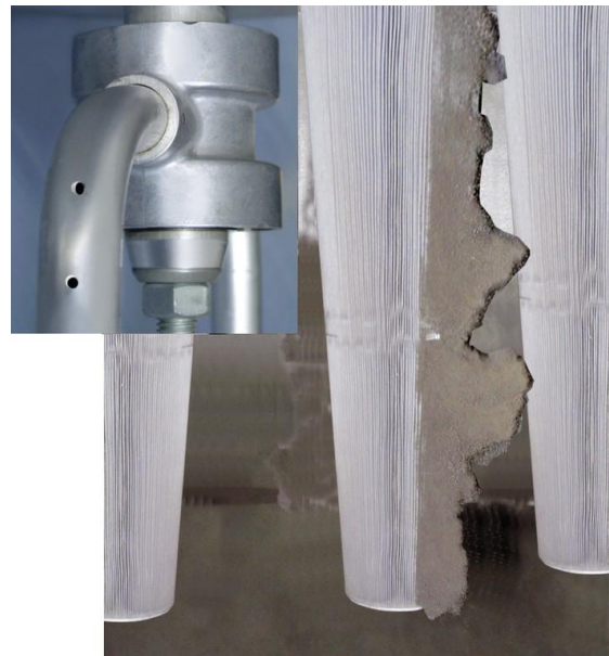
Rotationsluftdüse bei der Abreinigung
