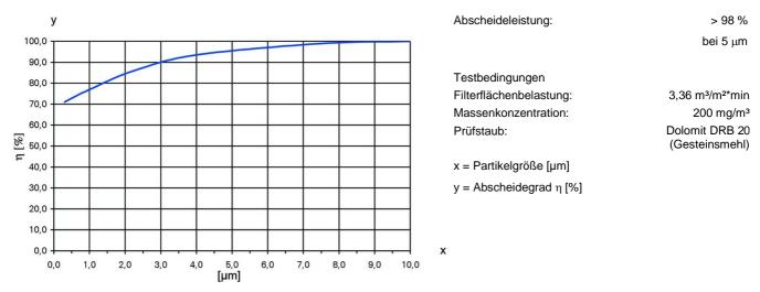
Abweichungen von diesen Werten sind bedingt durch Staubart, Gaszusammensetzung und Filterelementaufbau möglich.
