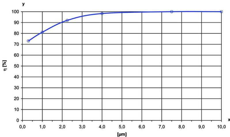
Abscheideleistung: > 98 % bei 4 μm
