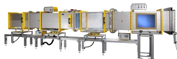
Filtrer le banc d'essai après EN779:2012 / ISO 16890 / Ashrea 52.2
