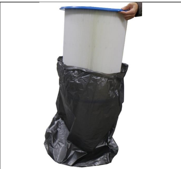
7.) Gebrauchtes Filterelement in die dafür vorgesehene Verpackung stellen.
