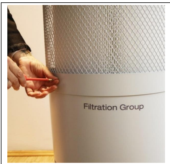
12.) Sicherungsschrauben aufsetzen und festziehen.
