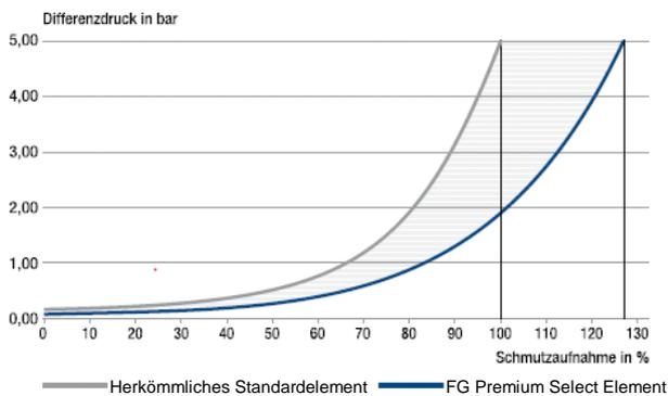
Dauerhaft mehr Leistung plus längere Standzeit: Innovatives Premium Select Element mit 30 % mehr Schmutzaufnahmekapazität, niedrigerem Differenzdruck und optimiertem Differenzdruckverlauf – für reduzierten Energieverbrauch.
