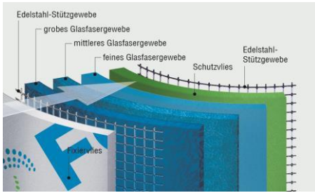
Aufbau eines PS-Faltensterns
